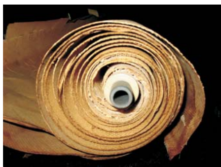
Fouled TFC membrane module
